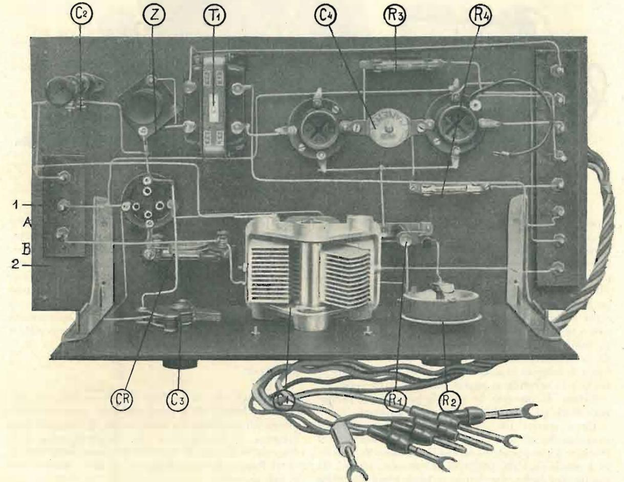
del condensatore di accordo si fisserà il reostato  $R_1$  che regola l'accensione della prima valvola. Questo reostato del resto potrebbe essere montato nell'interno; ma una tale modifica è solamente permessa al dilettante più esperto affinché non siano create confusioni di montaggio.
