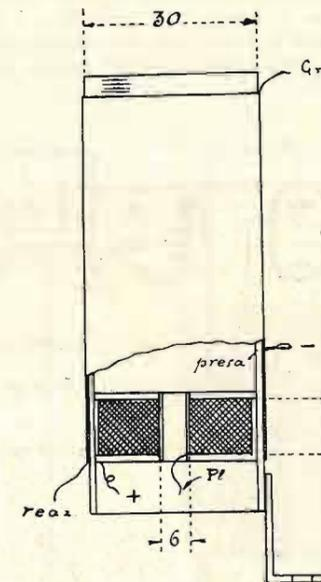
Fig. 4. — Un trasformatore per alta frequenza.
